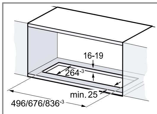
**2. Crie o recorte para o tubo de extração acima do móvel embutido ou atrás do móvel embutido por cima do aparelho.**
