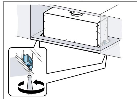
3. Enrosque os dois parafusos dianteiros e selecione o orifício de forma a que a superfície do aparelho enoste de forma rematada no móvel de embutir.
