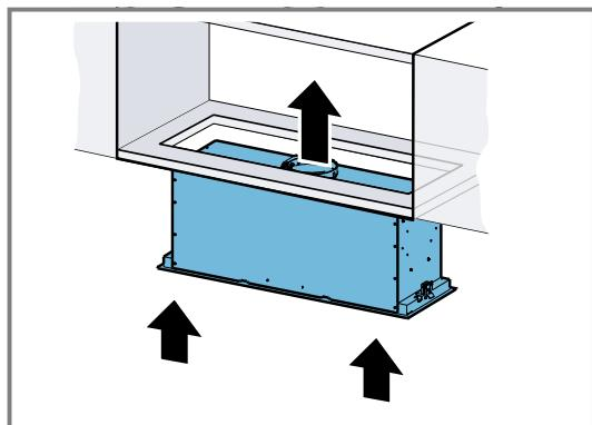
2. Aperte alternadamente os dois parafusos de fixação à esquerda e direita. Utilize uma ferramenta adequada para não danificar a superfície.
