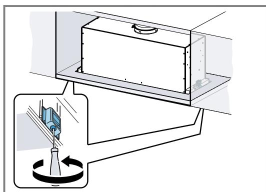
3. Enrosque os dois parafusos dianteiros e selecione o orifício de forma a que a superfície do aparelho enoste de forma rematada no móvel de embutir.
