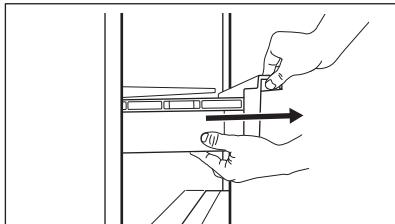
2. Levante la parte delantera del cajón.
