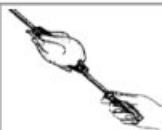
Enfiar a ponta livre do espeto no furo do motor, existente na parede posterior do forno, verificando o correcto encaixe do espeto no motor.
