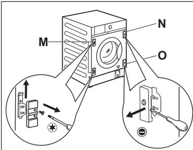
Se a porta do armário tiver de ser aberta da esquerda para a direita, inverta a posição dos suportes da dobradiça **M** com a placa magnética **N** e a placa inferior **O**.
