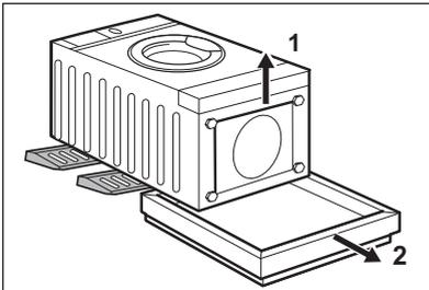
4. Coloque novamente o aparelho na posição vertical e retire a proteção de poliestireno da tomada.
