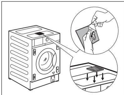
O aparelho está também equipado com uma almofada de esponja adesiva H que pode encontrar no interior do tambor. Fixe-a na parte superior do aparelho, conforme indicado no desenho. Ao nivelar o aparelho sob os móveis, **NÃO** esprema a almofada de esponja.
