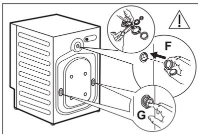
7. Feche os orifícios com as tampas de plástico que se encontram no saco do manual do utilizador. Coloque a tampa mais pequena **F** no orifício superior e as duas tampas maiores **G** nos orifícios inferiores.
