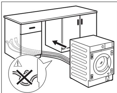
Antes de avançar com a instalação do aparelho, aproxime-o do recuo e pré-posicione o tubo de admissão, o tubo de escoamento e o cabo de alimentação.
