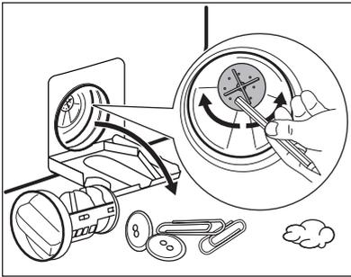
7. Se necessário, retire o algodão e todos os objetos estranhos da cavidade do filtro. Certifique-se de que o impulsor da bomba pode rodar. Se não rodar, contacte um Centro de Assistência Técnica Autorizado.
