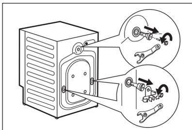
6. Remova os três parafusos, os suportes de mangueira e os espaçadores de plástico com a chave fornecida com o aparelho.
