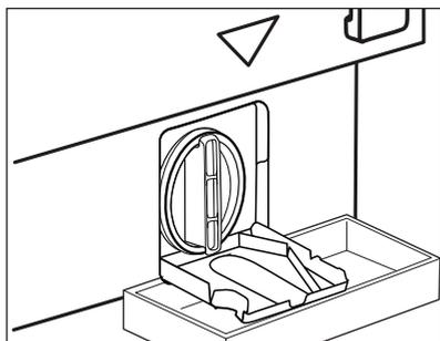
2. Coloque um recipiente adequado por baixo da acesso à bomba de escoamento para recolher a água que sair. Tenha sempre um pano à mão para secar os salpicos de água depois de retirar o filtro.
