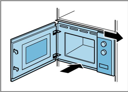
**3. Atornillar el aparato hasta que quede en posición central.**
