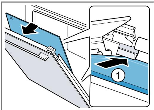
2. **Nota:** O vidro intermédio posiciona-se automaticamente através do movimento rotativo do suporte distanciador. Insira o segundo vidro intermédio no suporte central ① e coloque em cima.
