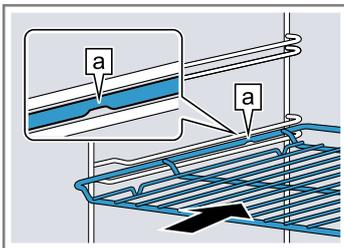
Tabuleiro P. ex., tabuleiro universal ou tabuleiro Insira o tabuleiro com a chanfradura [b] virada para a porta do aparelho.
