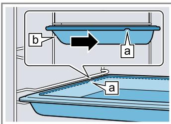
3. Para colocar o acessório no caso de níveis de inserção com calhas extensíveis, extraia as calhas extensíveis.
