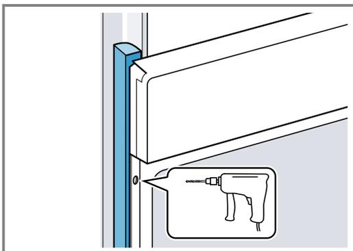
4. Fixar o aparelho com um parafuso adequado.
