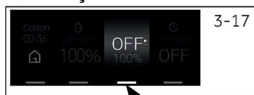
Tocar no botão "Amaciador" (Fig. 3-17) para seleccionar a função de amaciador (DESL/100%).
