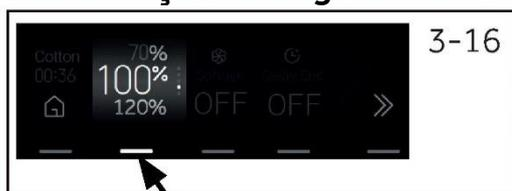
Toque no botão "Detergente" (Fig.3-16) para seleccionar a dosagem de detergente (DESL/40%/70%/100%/120%).
