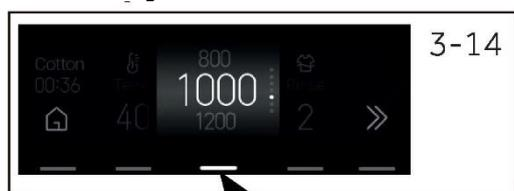
1. Tocar no botão "Velocidade" (Fig. 3-14) para seleccionar uma velocidade diferente (0/400/600/800/1000/1200/1400).
