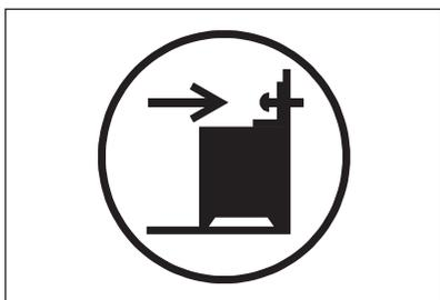
1. Instale a proteção anti-inclinação B - 343 mm abaixo da superfície superior do aparelho e A - 67 mm a partir da parte lateral do aparelho, no orifício circular num suporte. Aparafuse-a num material sólido ou utilize um reforço aplicável (parede).
