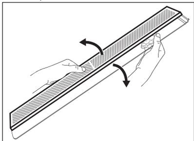
3. Monte uma nova membrana na tampa pressionando a extremidade da membrana na tampa.
