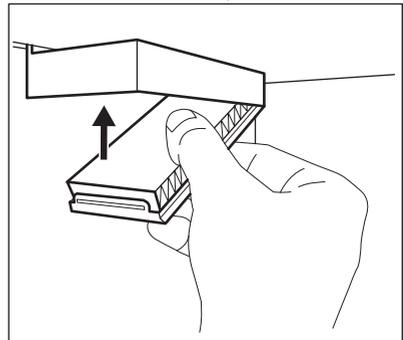
5. Após a substituição do filtro, prima o botão de alarme Filter Reset no painel de comandos para desligar o alerta.
