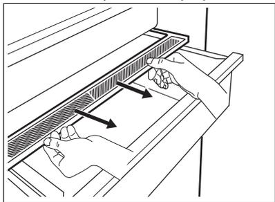
2. Se precisar de substituir a membrana branca do dispositivo, agarre o dispositivo no meio e separe a membrana da tampa puxando a tampa.
