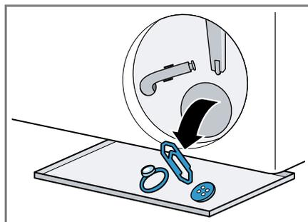
3. Assegure-se de que a roda de pás da bomba de escoamento se deixa girar.
