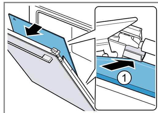
2. **Nota:** O vidro intermédio posiciona-se automaticamente através do movimento rotativo do suporte distanciador.
