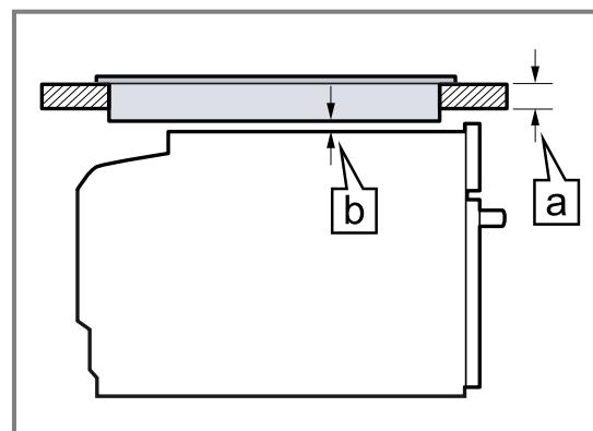
En función de la separación mínima necesaria, **b** se determina el grosor mínimo de la encimera **a**.
