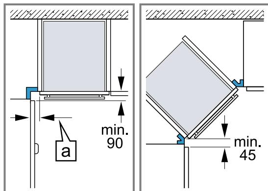
Para que sea posible abrir la puerta del aparato, observar las medidas mínimas en el montaje en esquina. La medida **a** depende del grosor del frontal del mueble y del tirador.
