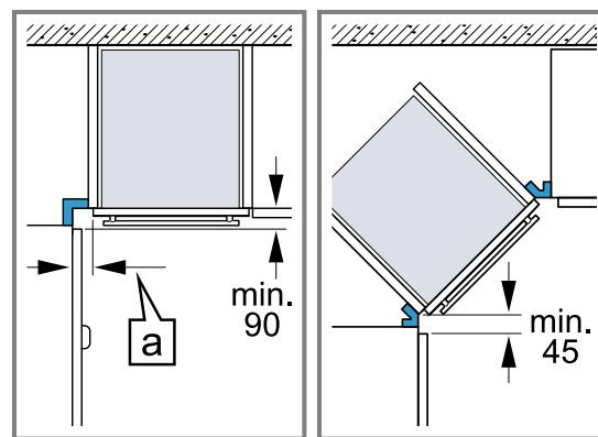
De modo a conseguir abrir a porta do aparelho, respeite as medidas mínimas ao efetuar a montagem de canto. A medida **a** depende da espessura da frente do móvel e do puxador.
