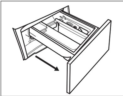
2. Remova a parte superior do compartimento de aditivo para facilitar a limpeza e lave-o em água morna corrente, para remover todos os vestígios do detergente acumulado. Após a limpeza, coloque a parte superior na devida posição.
