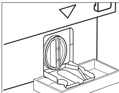
**2.** Coloque um recipiente adequado por baixo da acesso à bomba de escoamento para recolher a água que sair.
