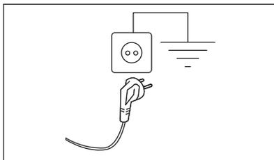
O cabo de alimentação deve estar acessível após a instalação da máquina
