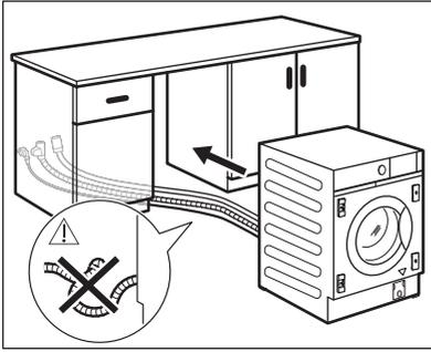
Antes de avançar com a instalação do aparelho, aproxime-o do recuo e pré-posicione o tubi de admissão, o tubo de escoamento e o cabo de alimentação.
