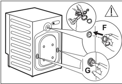
7. Feche os orifícios com as tampas de plástico que se encontram no saco do manual do utilizador. Coloque a tampa mais pequena **F** no orifício superior e as duas tampas maiores **G** nos orifícios inferiores.
