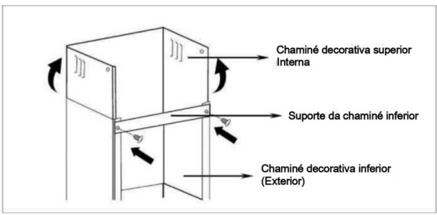
Perfure 2 orifícios para montar a placa II. Aparafuse e fixe a placa II na parede com os dois parafusos e buchas fornecidos. Faça deslizar para cima a chaminé superior e fixe-a à placa II com os 2 parafusos ST4 x 8 mm
