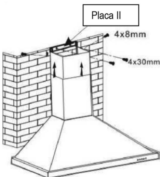
Fixe a chaminé inferior ao exaustor com 2 parafusos ST4 x 8 mm
