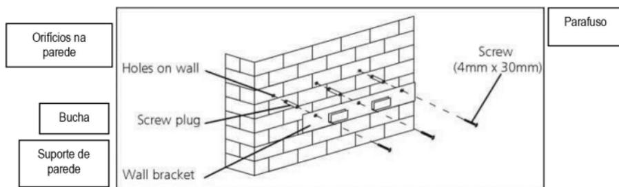
Levante o exaustor e pendure-o sobre os ganchos do suporte da parede.
