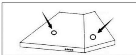
Fixe a válvula de retenção da saída de ar do exaustor. Em seguida, monte o tubo de escape na válvula de retenção, conforme ilustrado.
