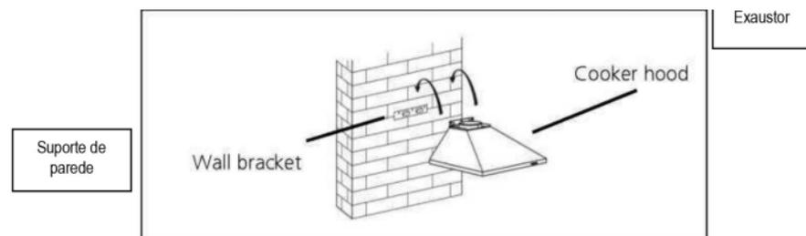
Depois de pendurar o exaustor sobre o suporte, remova os filtros de alumínio, marque 2 orifícios dentro do exaustor para os parafusos de segurança. Depois da marcação, remova o exaustor, perfure dois orifícios e insira 2 buchas e, finalmente, fixe os parafusos de segurança com 2 parafusos ST4 x 3 cm.
