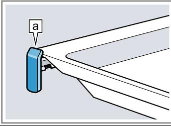
**Nota:** Totalmente extraídas, as calhas extensíveis engatam. Empurre as calhas extensíveis para o interior do aparelho exercendo alguma pressão.
