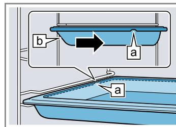
3. Para colocar o acessório no caso de níveis de inserção com calhas extensíveis, extraia as calhas extensíveis.
