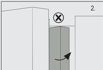
Se tentar fechar a porta esquerda e a barra vertical da mesma não se encontrar dobrada (2), deve em primeiro lugar dobrá-la, caso contrário a barra da porta baterá no eixo de fixação ou na porta do lado direita. Assim, ocorrerão danos no deslizamento da porta ou uma fuga.
