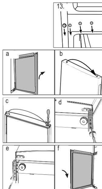
14. Retirar as novas dobradiças da bolsa de acessórios e aparafusar a nova dobradiça inferior do outro lado da abertura da porta.
