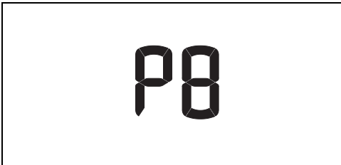
Fig. 13 P8 - Controlo de luminosidade
