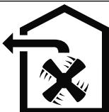
El aire no se puede desviar a una chimenea que se use para los gases residuales del aparato que quemen gas u otros combustibles (esto no se aplica a los aparatos de recirculación de aire).
