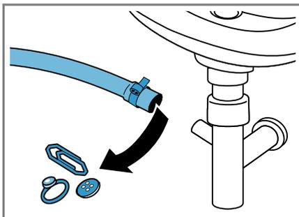
5. Encaixar a mangueira de escoamento de água e o ponto de união com a abraçadeira de mangueira.
