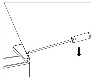
2. Desenrosque a dobradiça superior com uma chave de fenda Philips.
