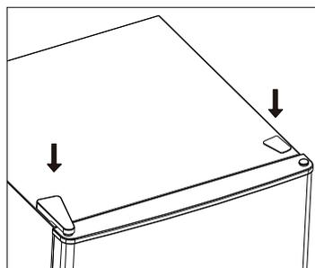
15. Verifique se a junta da porta está deformada. Se sim, retire o refrigerante e as juntas da porta do congelador e, em seguida, anexe-as depois de rodar.
