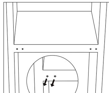
11. Levante a unidade e coloque a porta na dobradiça inferior. Certifique-se de que o núcleo da dobradiça inferior está inserido no orifício da porta. Em seguida, mova a tampa do orifício da dobradiça da porta inferior do lado esquerdo para o lado direito.
