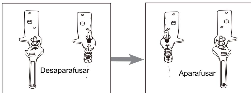
9. Instale a dobradiça no lado esquerdo e a base do pé no lado direito. Em seguida, aparafuse os dois pés niveladores com as peças originais.
