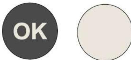
Se 'OK' não for exibido, a temperatura nessa parte está demasiado alta. Ajuste o termóstato para uma posição superior. Aguarde pelo menos 12 horas antes de voltar a regular o termóstato. Após a colocação de alimentos frescos no interior do aparelho ou após abertura repetida (ou prolongada) da porta, é normal que a indicação 'OK' não seja exibida no indicador de temperatura.
