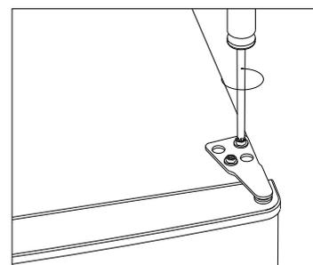
3. Retire a tampa do orifício com uma chave de fenda plana.
