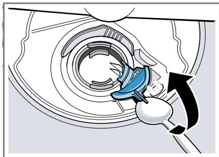
6. Levante a tampa da bomba de forma inclinada para dentro e retire.
