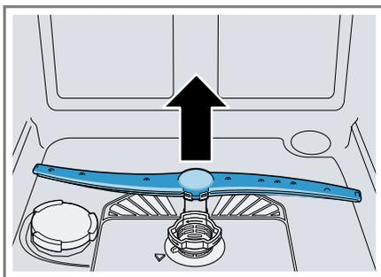
3. Verificar a existência de entupimentos nos orifícios de saída dos braços aspersores sob água corrente e, se necessário, remover os corpos estranhos.
