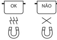
Utilize apenas frigideiras, tachos e panelas em material ferromagnético adequado para utilização com placas de indução:
