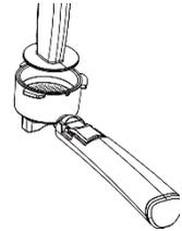
Conecte el portafiltros (11) a la máquina alineando el brazo del portafiltros (11) en el símbolo DESBLOQUEADO (🔓) y gírelo hasta que el brazo del portafiltros (11) esté alineado con el símbolo BLOQUEADO (🔒).
