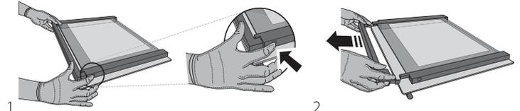
Levante e segure firmemente o vidro interior com ambas as mãos, removendo-o e colocando-o sobre uma superfície suave antes de proceder à sua limpeza (3).
