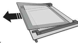
Para voltar a instalar o vidro interior, certifique-se de que a letra "R" está visível no canto esquerdo e que a superfície limpa (não impressa) está voltada para cima. Insira primeiro a parte mais longa do vidro com a indicação "R" nos alojamentos dos suportes e, em seguida, baixe-a até à posição correta (4). Instale novamente a extremidade superior (5): irá ouvir um clique, indicando que está bem posicionado. Certifique-se de que a vedação está segura antes de montar novamente a porta.
