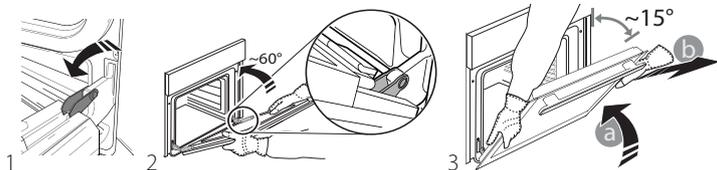
Coloque a porta de parte, apoiando-a sobre uma superfície suave. Reponha a porta, deslocando-a na direção do forno e alinhando os ganchos das dobradiças com os respetivos suportes, fixando a parte superior aos suportes. Baixe a porta e, em seguida, abra-a totalmente. Baixe as linguetas para a respetiva posição original: assegure-se de que as baixe totalmente. Tente fechar a porta e assegure-se de que está alinhada com o painel de controlo. Se não estiver, repita os procedimentos acima.
