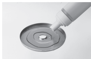
Fig4. Aplique el Gel de Encendido en el anillo alrededor del centro de la placa de encendido. Atención para no derramar Gel de Encendido fuera del anillo.
