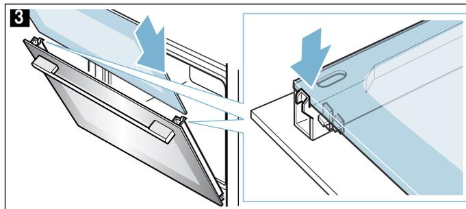
5. Coloque a moldura e pressione-a, até a mesma encaixar de forma audível (figura 4).
