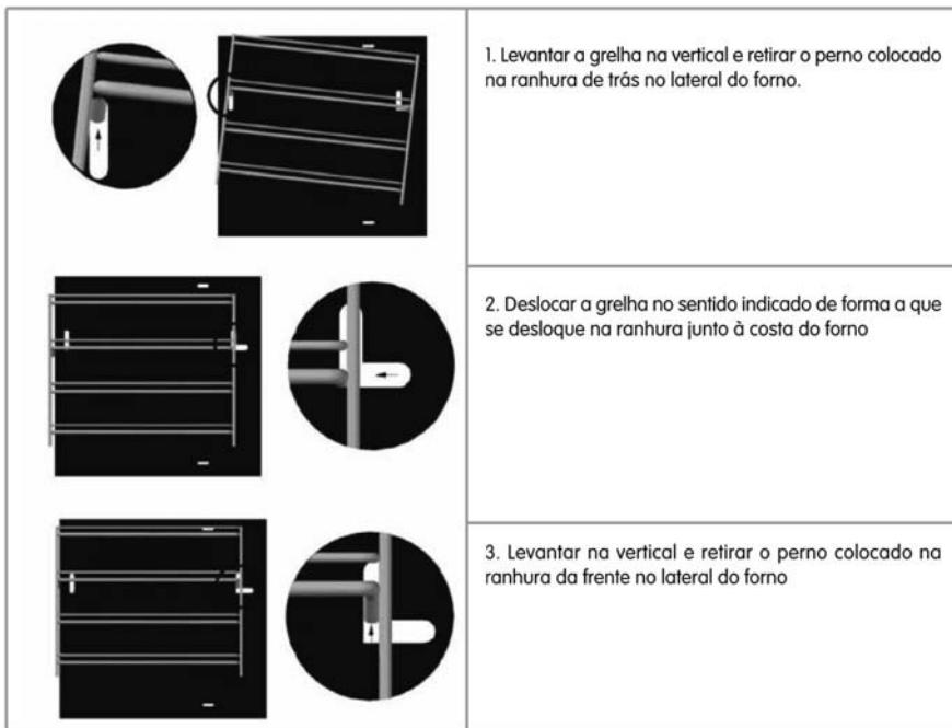
As guias telescópicas em aço inox que suportam as assadeiras esmaltadas podem ser retiradas e colocadas nos 3 níveis das grelhas laterais.
