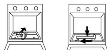
3.3 - Retirar o injector do seu suporte e substitui-lo pelo adequado ao gás com o qual o aparelho vai trabalhar (ver quadro 1).
