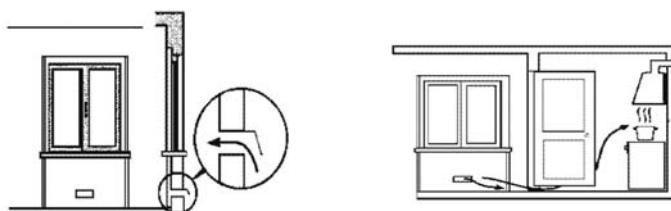
Las ventilaciones de entrada de aire deben tener la sección mínima de 100 cm<sup>2</sup> y no pueden ser obstruidas accidentalmente. Para los aparatos sin seguridad en los quemadores del plano de trabajo, las aberturas de entrada de aire deben tener la sección mínima de 200 cm<sup>2</sup>.
