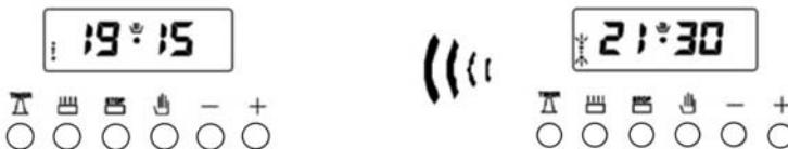
Cuando la cocción automática está completa, una alarma se activa y sonará, si no se interrumpe, durante 7 minutos.
