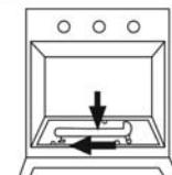
3.3 - Retirar el inyector y substituirlo por el adecuado al gas con el cual el aparato va a trabajar (ver cuadro 1).
