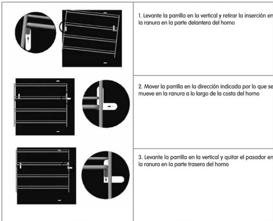
Las guías de acero inoxidable que apoyan la bandeja esmaltada pueden ser removidas y colocadas en tres niveles de parrillas laterales.
