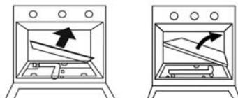
3.2 - Retirar o queimador desapertando os parafusos de fixação, puxando-o para o lado e levantando-o, puxar para a frente.
