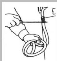
La conexión de la cocina debe ser efectuada del mismo lado al punto de la alimentación, de forma que el tubo no cruce los laterales del aparato.
