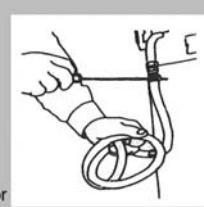
A ligação no fogão deve ser efectuada do mesmo lado do ponto de alimentação, de modo a que o tubo não cruze as costas do aparelho. Se necessário troque o porta-tubos com o tampão. Para alguns modelos, com uma única entrada de gás, solicite aos serviços de assistência técnica o tubo de adaptação para que a entrada de gás no aparelho se efectue do lado correcto.
