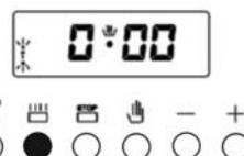
2) Cambiar el modo de cocción. (Pulse (2))
