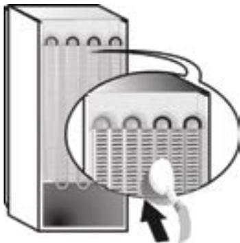
Para garantir o correto e constante fluxo da água de descongelação, limpe regularmente o interior do orifício de drenagem situado na secção posterior do frigorífico, junto da gaveta para fruta e legumes, utilizando o instrumento fornecido.
