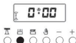
2) Cambiar el modo de cocción. (Pulse (2))
