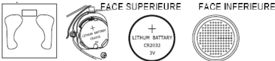
Remarque : la pile est correctement insérée lorsque le pôle positif est en haut et que le pôle négatif est en bas. Après avoir inséré la pile, l'écran affiche « HI ». Ne montez pas encore sur la balance. Dans le cas contraire, la pesée serait incorrecte.
