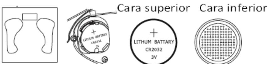
(Importante: para poner la pila correctamente, el polo positivo debe estar hacia arriba y el polo negativo hacia abajo) . Después de colocar la pila, debería aparecer "HI" en la pantalla.
