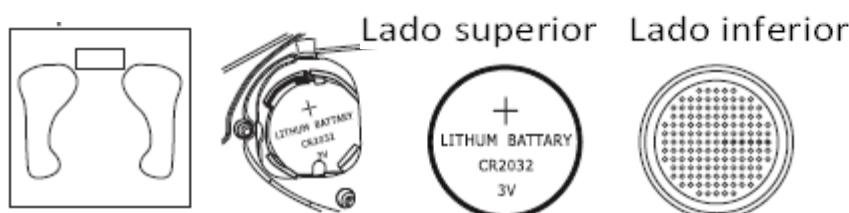
Nota: Para inserir a pilha correctamente, o pólo positivo deve estar virado para cima e o pólo negativo para baixo. Depois de inserir a pilha, a indicação "HI" deverá surgir no ecrã. Não suba para cima da balança nesta altura, visto que o resultado da pesagem seria incorrecto.
