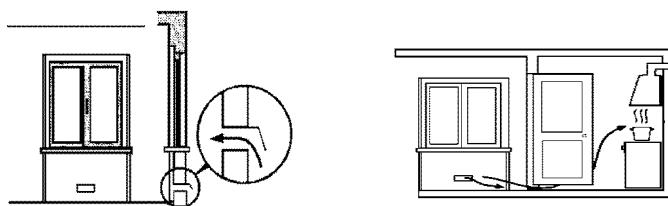
Las ventilaciones de entrada de aire deben tener la sección mínima de 100 cm<sup>2</sup> y no pueden ser obstruidas accidentalmente. Para los aparatos sin seguridad en los quemadores del plano de trabajo, las aberturas de entrada de aire deben tener la sección mínima de 200 cm<sup>2</sup>.
