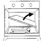
3.2 - Retirar el quemador aflojando el tornillo de fijación
