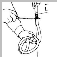
La conexión de la cocina debe ser efectuada del mismo lado al punto de la alimentación, de forma que el tubo no cruce los laterales del aparato.
