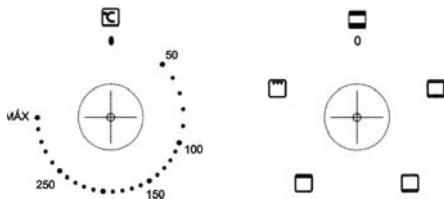
De seguida escolha no comutador do termóstato a temperatura desejada de funcionamento.
