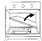
3.2 - Retirar o queimador desapertando os parafusos de fixação, puxando-o para o lado e levantando-o, puxar para a frente.
