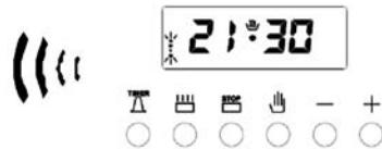
Cuando la cocción automática está completa, una alarma se activa y sonará, si no se interrumpe, durante 7 minutos.
