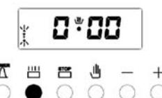
2) Cambiar el modo de cocción. (Pulse (2))
