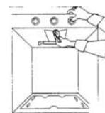
Para apagar la llama del quemador basta girar el mando de la llave en el sentido izquierdo hasta la posición de "apagado", representada por un círculo en la parte superior del panel. ●
