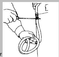
A ligação no fogão deve ser efectuada do mesmo lado do ponto de alimentação, de modo a que o tubo não cruze as costas do aparelho. Se necessário troque o porta-tubos com o tampão. Para alguns modelos, com uma única entrada de gás, solicite aos serviços de assistência técnica o tubo de adaptação para que a entrada de gás no aparelho se efectue do lado correcto.
