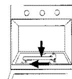
3.3 - Retirar el inyector y substituirlo por el adecuado al gas con el cual el aparato va a trabajar (ver cuadro 1).
