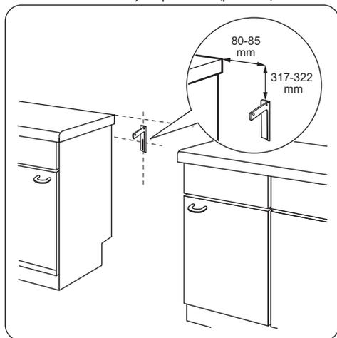
2. O orifício encontra-se no lado esquerdo da parte de trás do aparelho. Levante a parte da frente do aparelho e coloque-o no meio do espaço entre os armários. Se o espaço
