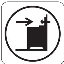
1. Instale a protecção anti-inclinação 317-322 mm abaixo da superfície superior do aparelho e 80-85 mm a partir da parte lateral do aparelho, no orifício circular do suporte. Aparafuse-a em material sólido ou utilize um reforço aplicável (parede).
