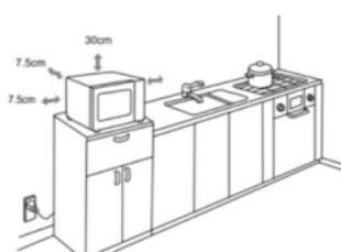
O forno micro-ondas deverá ser colocado sobre uma superfície lisa e estável, adequada a suportar o seu peso e o dos alimentos mais pesados a serem cozinhados no forno.
