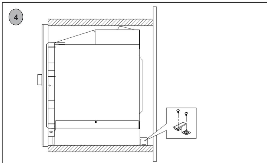
4 - O suporte B do fundo está instalado apenas na parte de trás do aro de encaixe do forno.
