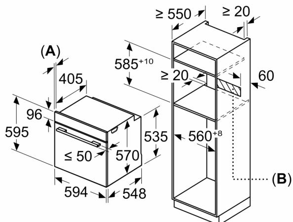
Instalação com uma placa de cozinhar.
