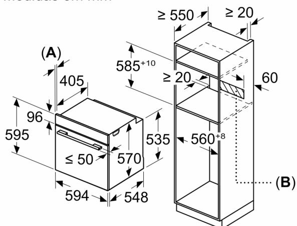
Instalação com uma placa de cozinhar.
