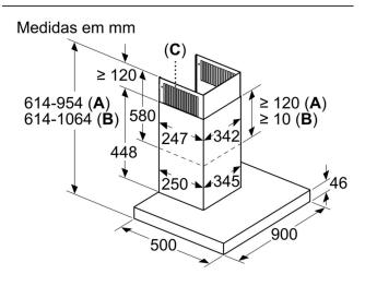
A: ExtraçãoB: Circulação de arC: Saída de ar - em caso de extração, montar com as ranhuras viradas para baixo
