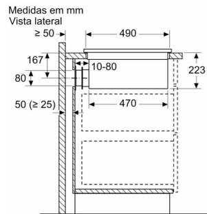
Ao instalar diretamente em paredes exteriores não isoladas ( $\mu \geq 0.5 \text{ W/m}^2 \cdot \text{C}$ ), recomendamos a utilização de configurações de recirculação em conduta parcial ou total.
