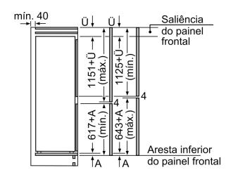
As medidas indicadas das portas dos móveis são válidas para uma junta de porta de 4 mm. Medidas em mm Medidas em mm Recomendação medidas da folga para dobradiça plana
