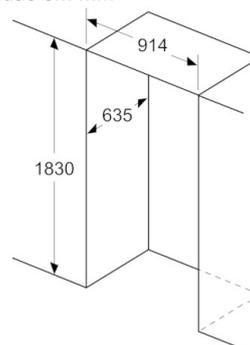
**A:** Se instalar o aparelho num nicho, respeite as dimensões apresentadas
