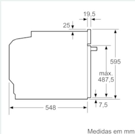
Instalação com uma placa de cozinhar.
